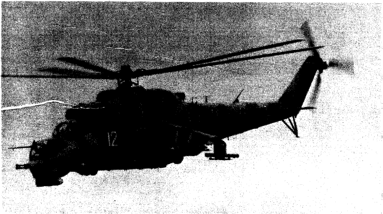
Foto 5: HIND-E, uitgerust met voorziening om extra AT-6/SPIRALs mee te voeren en mogelijk antenne t.b.v. nieuwe D-band IFF systeem.
