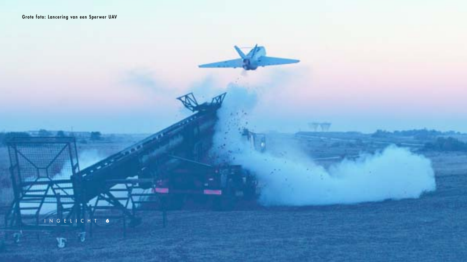
Het lanceervoertuig: een pneumatische katapult
