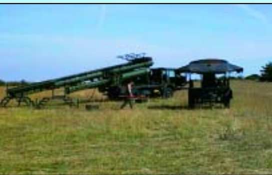
Het lanceervoertuig: een pneumatische katapult
