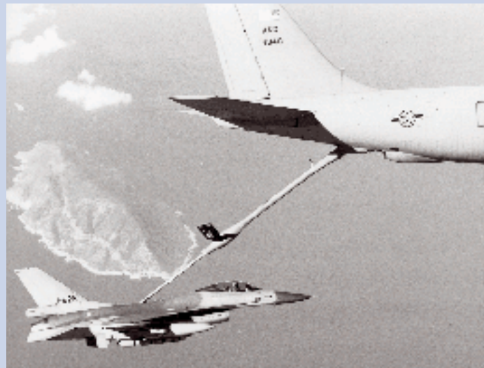
Air to air refueling van een Nederlandse RF-16 die is voorzien van een Orpheus 'recce pod'
