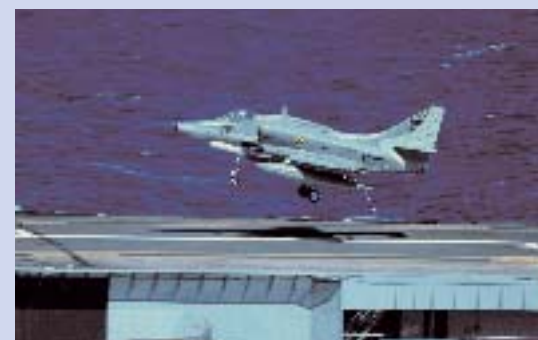
De N-1014 tijdens de landing voordat de vanghaak een van de drie kabels op het vliegdek grijpt
