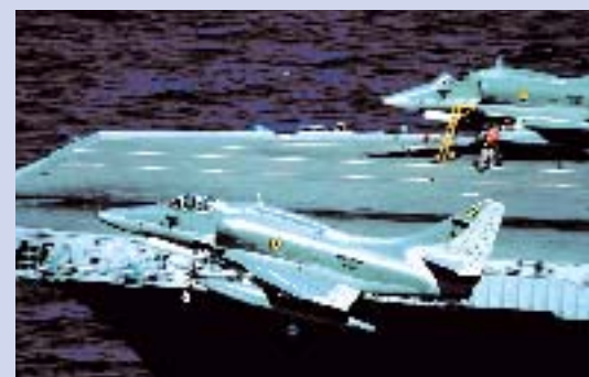
Een AF-1 N-1011 van VF-1 wordt vanaf het hoekdek door een stoomkapuit gelanceerd naar een snelheid van 0 naar 250 km per uur
